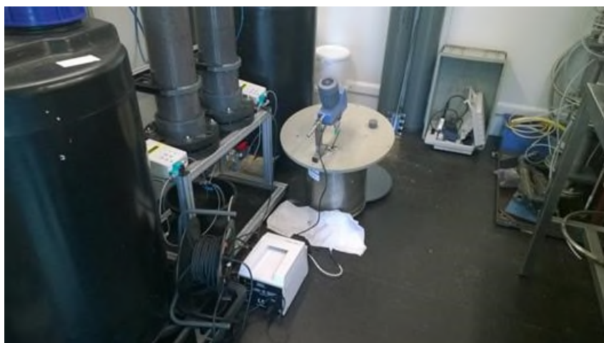
FIGUUR 4-2: DOSERING VAN 105 G PAC IN 10 L MILLI-Q WATER OP DE GROTERE TESTKOLOM, ONDERIN DE KOLOM AANGEBRACHT
