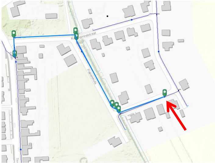
FIGUUR 1. SPUIPLAN VAN LOCATIE IN HET VOORZIENINGSGBIED VAN BRAAKMAN: PAPANMUTS 31, IJZENDIJKE. ER ZIJN GEEN AFSLUITERS DICHT GEZET. ER IS GESPUID OP DE MET PIJL AANGEGEVEN BRANDKRAAN (0404-YZ). UITGEVOERD OP 13 JUNI 2017.
