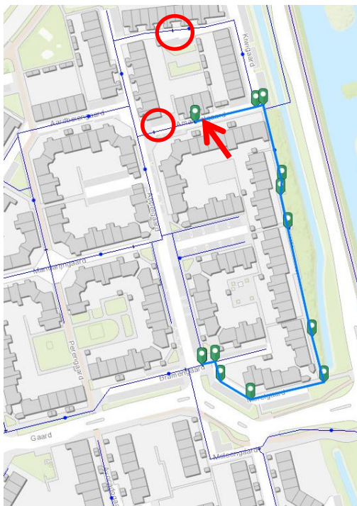
FIGUUR 2. SPUIPLAN VAN LOCATIE IN HET VOORZIENINGSGBIED VAN BERENPLAAT: AMANDELGAARD 6, SPIJKENISSE. DE TWEE AANGEGEVEN AFSLUITERS (G19641, G19636) ZIJN GESLOTEN EN ER IS GESPUID OP DE MET PIJL AANGEGEVEN BRANDKRAAN (HYDR-21841). UITGEVOERD OP 13 JUNI 2017.
