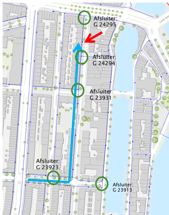
FIGUUR 3. SPUIPLAN VAN LOCATIE IN HET VOORZIENINGSGBIED VAN KRALINGEN: ROTTERDAM, SCHANS 7A. DE VIJF AANGEGEVEN AFSLUITERS ZIJN GESLOTEN EN ER IS GESPUID OP DE MET PIJL AANGEGEVEN BRANDKRAAN (HYDR-26625). UITGEVOERD OP 13 JUNI 2017.
