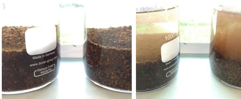
FIGUUR 8. 1-LITER FLESSEN GEVULD MET WATER EN FILTERMATERIAAL. EÉN VAN DE MATERIALEN, VERMOEDELIJK BIMS, ZAKT LANGZAAM UIT EN BLIJFT LANG IN HET WATER DRIJVEN.
