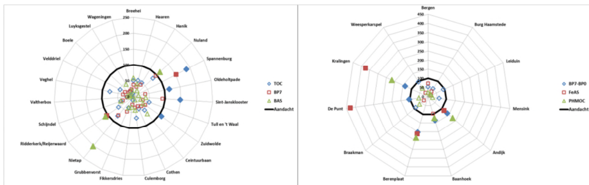
Radarplots voor aandachtsparameters van reinwater op locaties waar drinkwater uit grondwater (links) of oppervlaktewater (rechts) wordt bereid. Overschrijdingen van de aandachtswaarde zijn in deze radarplots aangegeven met dichte symbolen.
