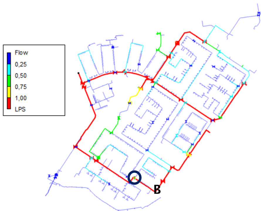
FIGUUR 5-4 VOLUMESTROOM MET AFSLUITEN VAN AFSLUITER B OM 8:00, DIAMETER 100 MM.
