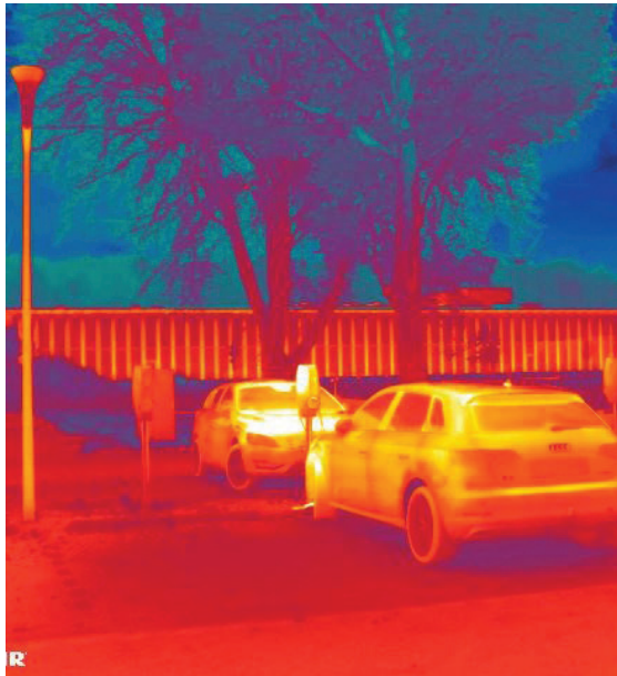
► Figuur 1. Antropogene warmte: de lantaarnpaal, het oplaadstation en de auto's zijn duidelijk warmer dan de omgeving (linker beeld), terwijl de bomen juist koeler zijn. Ook het transformatorhuisje (rechter beeld) is warm.
