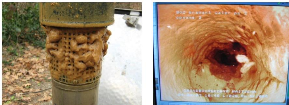
Figuur 3.8 Neerslagen in pompput 2A van winning Bergen op Zoom. Foto's uit Stuyfzand et al. (2016).
