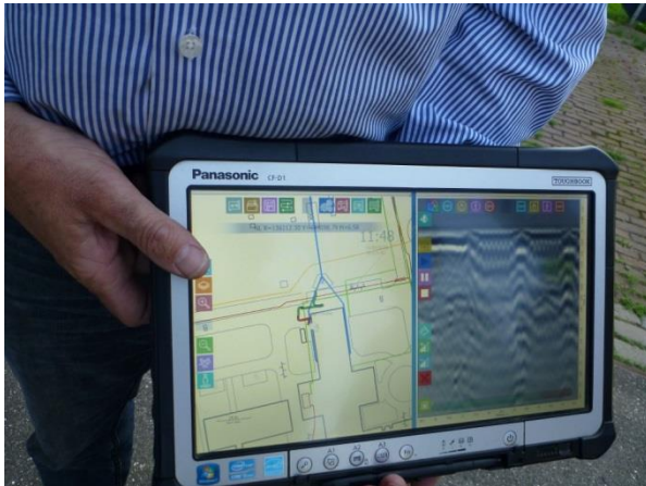
Detectie van leidingen met grondradar vereist deskundigheid en ervaring
