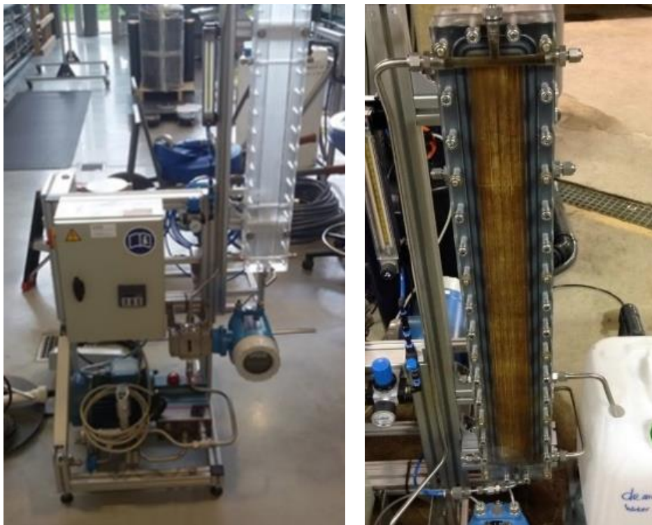
Afbeelding 6. Voedingsspacerloze RO-installatie. Links systeem zonder membraanvel. Rechts tijdens testen met oppervlaktewater 'Grecht'
