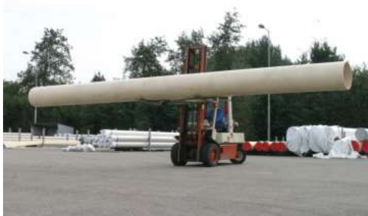
Foto bij onderdeel 2 van checklist 3.5 transport (zo NIET dus).
