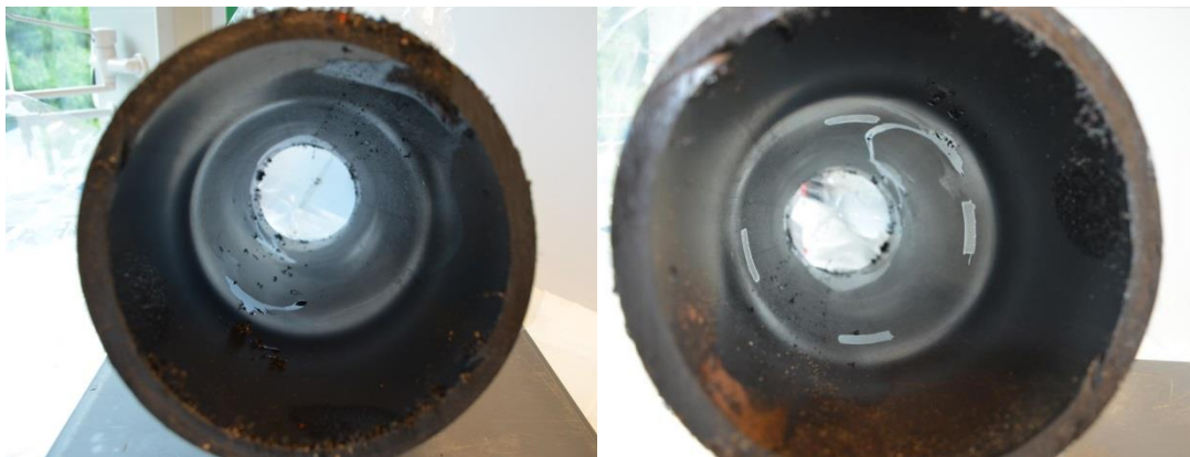
Figuur 46. PE-100 leiding, \varnothing 200 mm. Het plaatje links is voor het swabben, het plaatje rechts is na het swabben.
