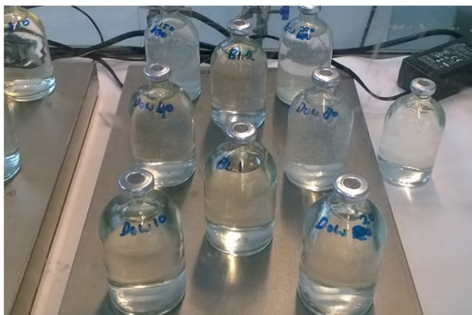
Figuur 2: Uitvoering van een adsorptie-isotherm op een roerplateau in de glovebox
