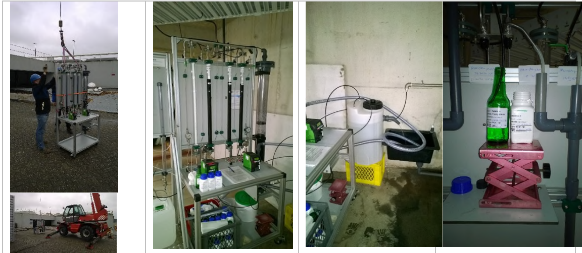
Figuur 3-1: Kolomopstelling in Kralingen. Van links naar rechts: plaatsing, opstelling, doseerunit en monstername
