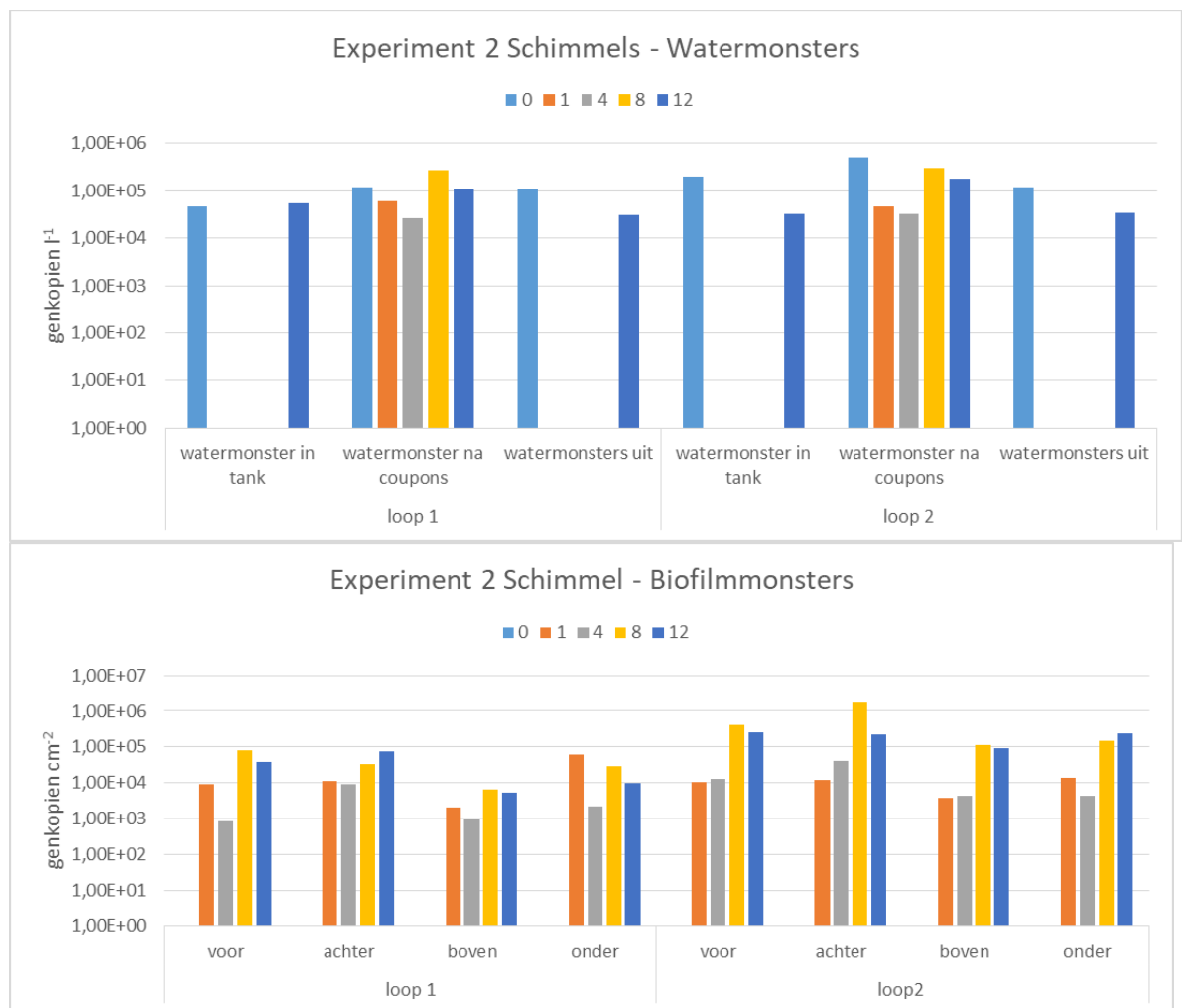
FIGUUR 40 DE 18S RRNA GENKOPIEEN VAN SCHIMMELS IN DE TIJD (DAG 0, WEEK 1, 4, 8 EN 12) IN HET WATER EN BIOFILM VAN EXPERIMENT 2.
