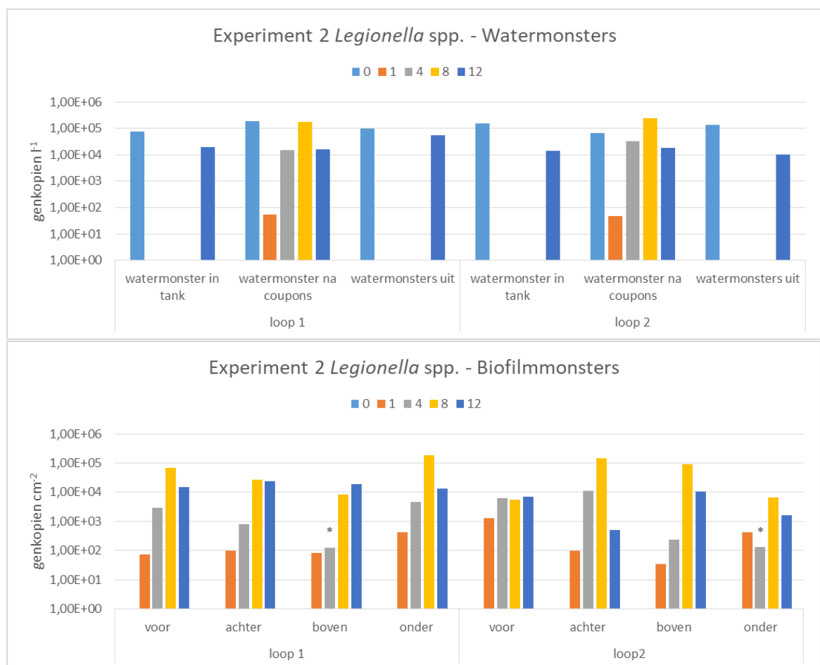
FIGUUR 32 DE 16S RRNA GENKOPIEEN VAN LEGIONELLA SPP. IN DE TIJD (DAG 0, WEEK 1, 4, 8 EN 12) IN HET WATER EN BIOFILM VAN EXPERIMENT 2. *=DETECTIELIMIET
