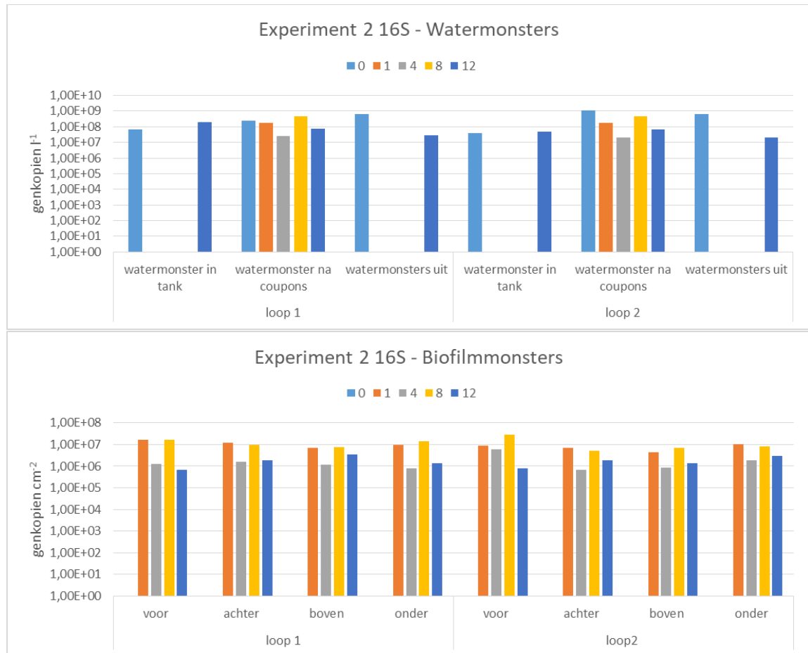
FIGUUR 28 DE 16S RRNA GENKOPIEEN IN DE TIJD (DAG 0, WEEK 1, 4, 8 EN 12) IN HET WATER EN BIOFILM VAN EXPERIMENT 2.
