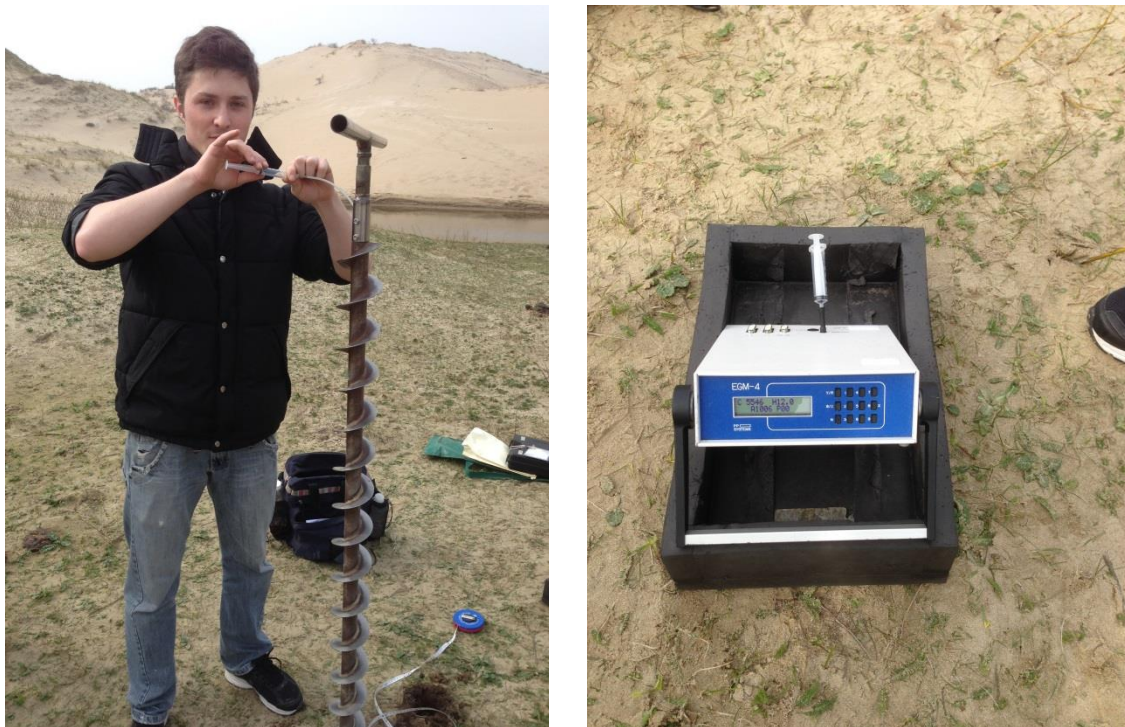
FIG. 6.1 Bemonstering van bodemlucht via de VU-spiraalboor (links) en in situ analyse op CO 2 , in de Kennemerduinen bij Kattendel. Foto Stuyfzand 2014.
