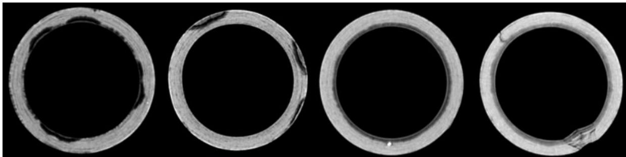
Eén CT scan maakt honderden doorsneden van een buis; daarin is aantasting duidelijk zichtbaar als donkere vlekken.
