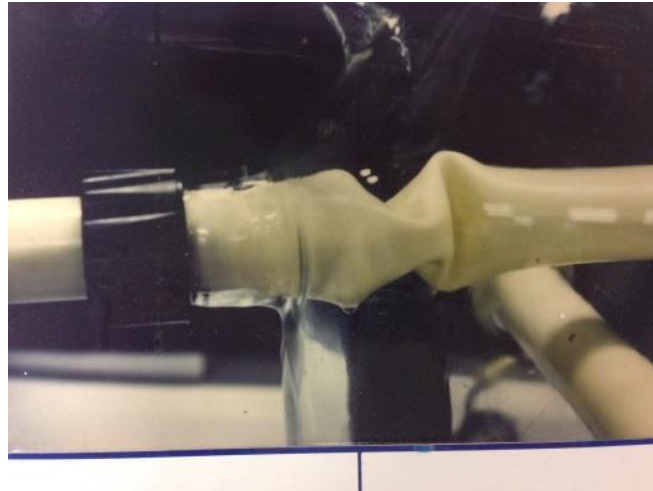
Foto 1 Een door toluen in de dampfase verweekte PVC buis.
