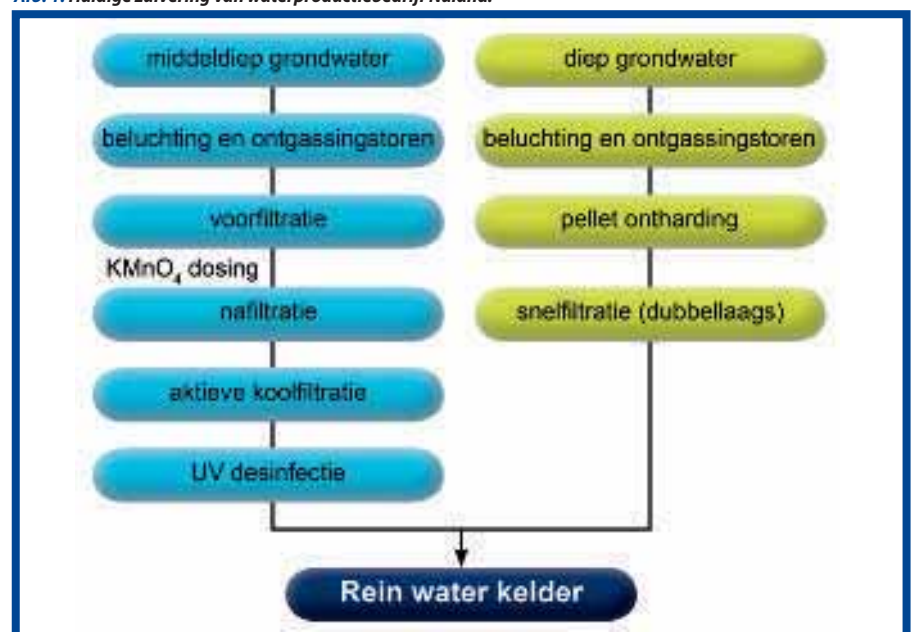
Afb. 1: Huidige zuivering van waterproductiebedrijf Nuland.
