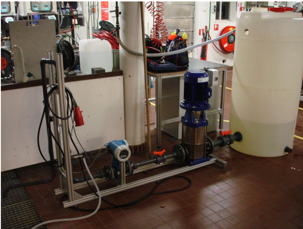
Figuur 5 Foto's Biofilm verwijdering opstelling
