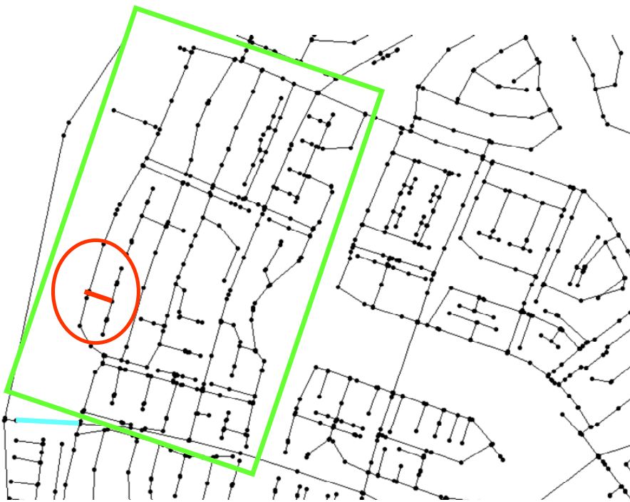
Figuur 3-2. Uitsnede Muziekwijk. In blauw: leiding (145 m) voor koelen wijk (scenario 3a, 3b, 17a, 17b). In rood: leiding (55 m) voor koelen straat (scenario 5a, 5b, 19a, 19b) en rood omcirkeld de leidingen waarvan de diameter is verkleind (scenario 9, 22). Dit is tevens het gebied waarop de lokale maatregelen op straatniveau worden geëvalueerd. Groen omkaderd: de wijk waarin verbruik wordt verhoogd (scenario 12, 25). Dit is tevens het gebied waarop de lokale maatregelen op wijkniveau worden geëvalueerd.
