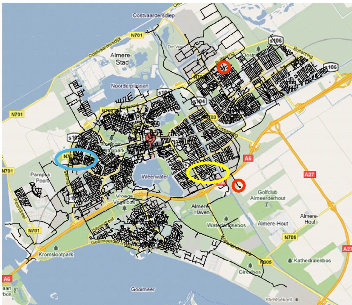
Figuur 2-3. Netwerkmmodel van Almere. Rood omcirkeld zijn reinwaterkelders (Westerterp in het zuiden, en Buitenterp in het noorden). Geel en blauw omcirkeld zijn twee wijken waarop lokaal is ingezoomd, zie § 3.3.
