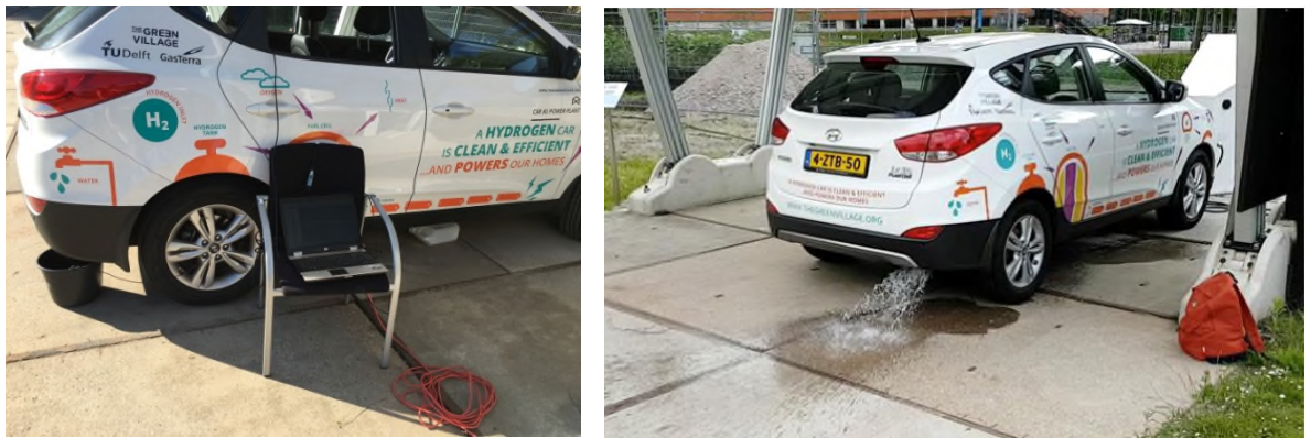
FIGUUR 72 DE HYUNDAI IX35 FUEL CELL OP DE TU DELFT. LINKS: DE EMMER EN WITTE JERRYCAN GEVEN AAN WAAR HET WATER WORDT OPGEVANGEN. RECHTS: EXTRA WATER WAT VRIJKOMT UIT DE AUTO NA UITSCHAKELLEN.
