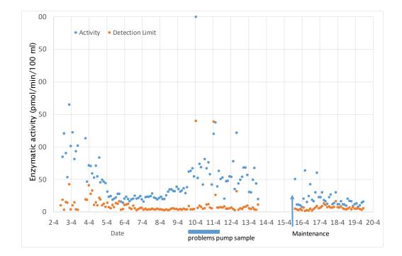
FIGURE 30. MEASUREMENTS OF ENTEROCOCCI IN LEKKANAAL-WATER AT NIEUWEGEIN WITH THE BACTCONTROL (BLUE). THE DETECTION LIMIT OF THE BACTCONTROL IS GIVEN (ORANGE).
