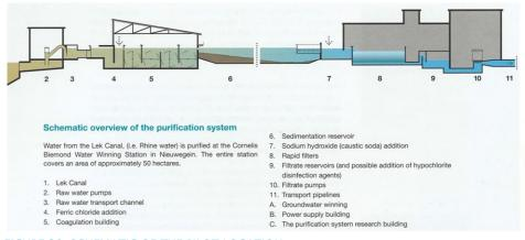
FIGURE 29. SCHEMATIC OF THE PILOT LOCATION
