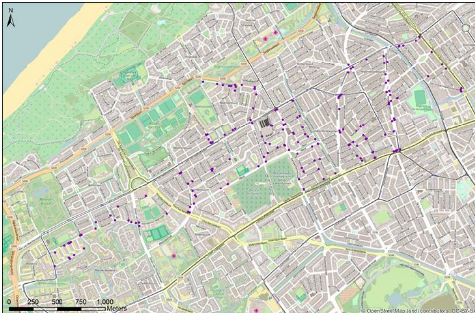
Figuur 3 Gebied voor testen afsluiters, paarse stippen zijn de geselecteerde te beproeven afsluiters
