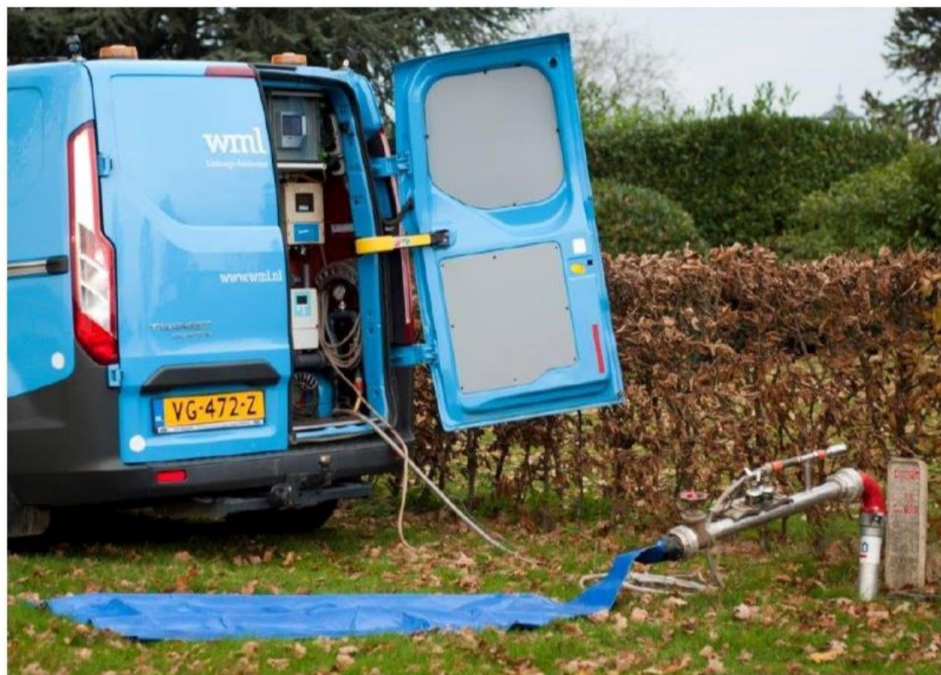
Figuur 6. Volledig ingericht meetpunt en aangepaste fittersbus. Op het spuijpunt is vanaf de bocht de volgende apparatuur aanwezig: T-stuk met aftak naar drukopnemer en troebelheidsmeter, snelheidsmeter voor de volumestroom, afsluiter en spuizak. In de bus zijn de troebelheidsmeter, snelheidsmeter, drukregistratie en datalogger opgesteld (hoffelijkheid van foto: WML, 2014).
