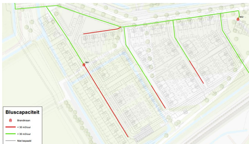
Figuur 11 Voorbeeld van Evides waarin voor een nieuwbouwplan wordt aangegeven welke leidingen een bluswatercapaciteit kunnen leveren van meer dan 30 \text{ m}^3/\text{h} .
