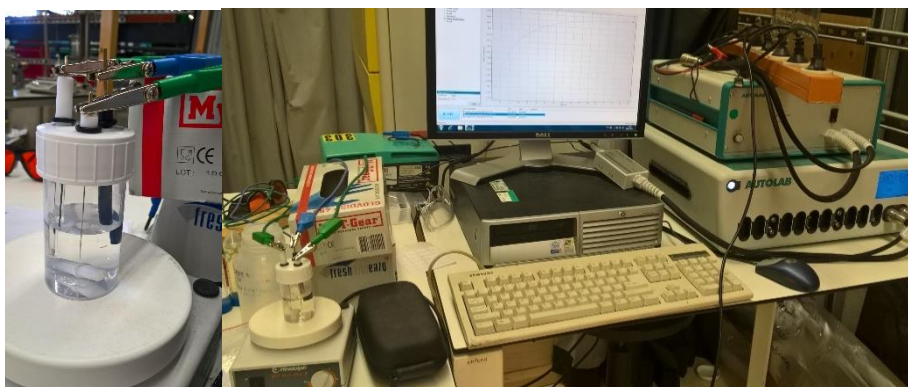
Figuur 4 Proefopstelling met de elektrochemische cel uitvergroet (links).
