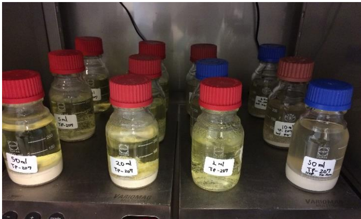
Figuur 1 Proef opzet bepalen adsorptie evenwicht.
