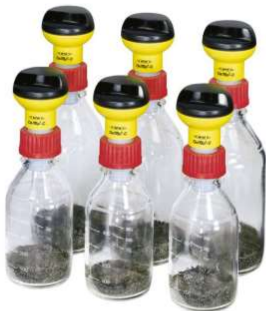
Figuur 8-1: voorbeeld van Oxitop opstelling met bovenop de fles een zuurstofsensor.
