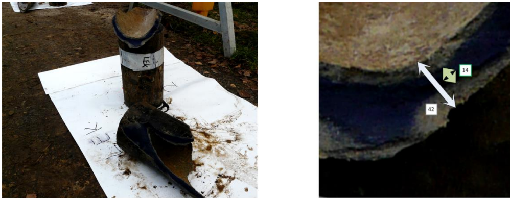
FIGUUR 5-3 METING MET THYMOFTALEÏNE VOOR HET SCHATTEN VAN DE EFFECTIEVE WANDDIKTE TER PLAATSE VAN DE BREUK. DE WAARDEN GEVEN DE LENGTE VAN DE PIJLEN IN MICROSOFT VISIO. DE VERHOUDING 14/42 STE VAN DE TOTALE WANDDIKTE KOMT OVEREEN MET 4,4 MM.
