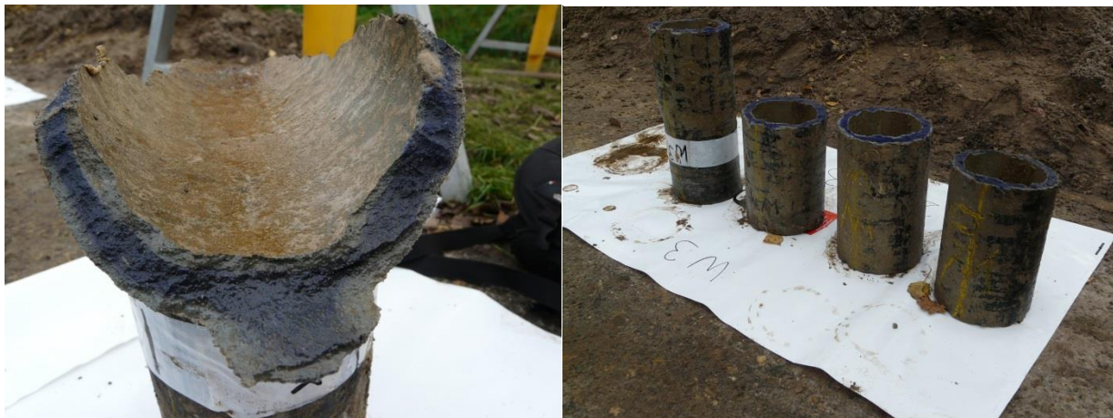
AC buisdelen gebruikt in dit onderzoek. Links, een scherf nadat een breuk optrad bij een persproef. Rechts, vier uitgeknipte delen waarvan het breukvlak nader is onderzocht. Op alle breukvlakken is thymolftaleïne aangebracht.
