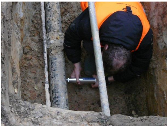
FIGUUR 6-1 TOEPASSING VAN EEN HARDHEIDSHAMER OP EEN ONTGRAVEN AC LEIDING
