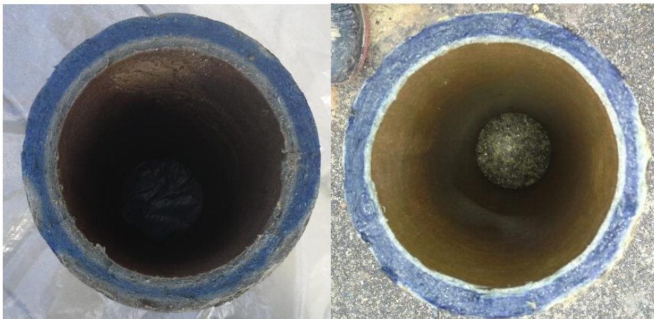
FIGUUR 2-1 TWEE VOORBEELDEN VAN EEN THYMOFLTALÉINEMETING. DE GRIJZE KLEUR GEEFT UITGELOOGD MATERIAAL WEER, IN DE BLAUWE DELEN IS NOG CALCIUM EN DAARMEE STERKTE AANWEZIG. LINKS BETREFT EEN BEOORDELING BIJ EEN SANERINGSWERK (BURGEMEESTER GERARDSTRAAT 3, POSTERHOLT), RECHTS BETREFT EEN STORING (Lollebeekstraat 75, Castenray).
