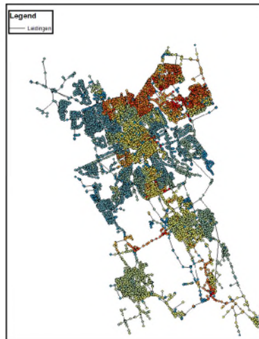
Figuur 3. De mate waarin de mengverhoudingen veranderen in de laatste 24 uur. Van blauw (niet/nauwelijks) tot rood (veel verandering) behorend bij het dominantiepatroon van figuur 1.
