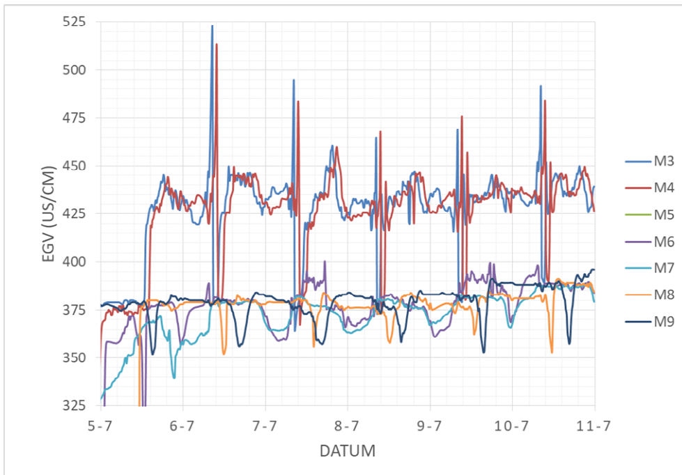
Figuur 16. Als Figuur 13, maar voor model A3. Signaal M5 bestaat uit EGV-waarden gelijk aan nul en valt buiten het bereik van de figuur.
