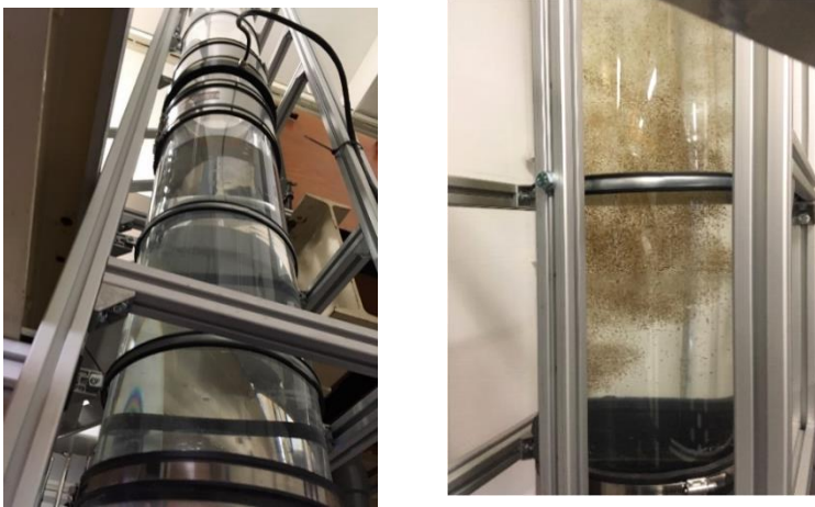
Figuur 11. Experimenten voor het bepalen van valsnelheden van deeltjes met de ITS P2+ Tomographer (eigendom: Universiteit van Sheffield).
