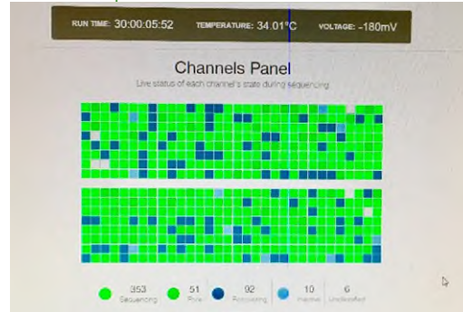
Figuur 10. Weergave van de actieve poriën in de membraan van de flowcell
