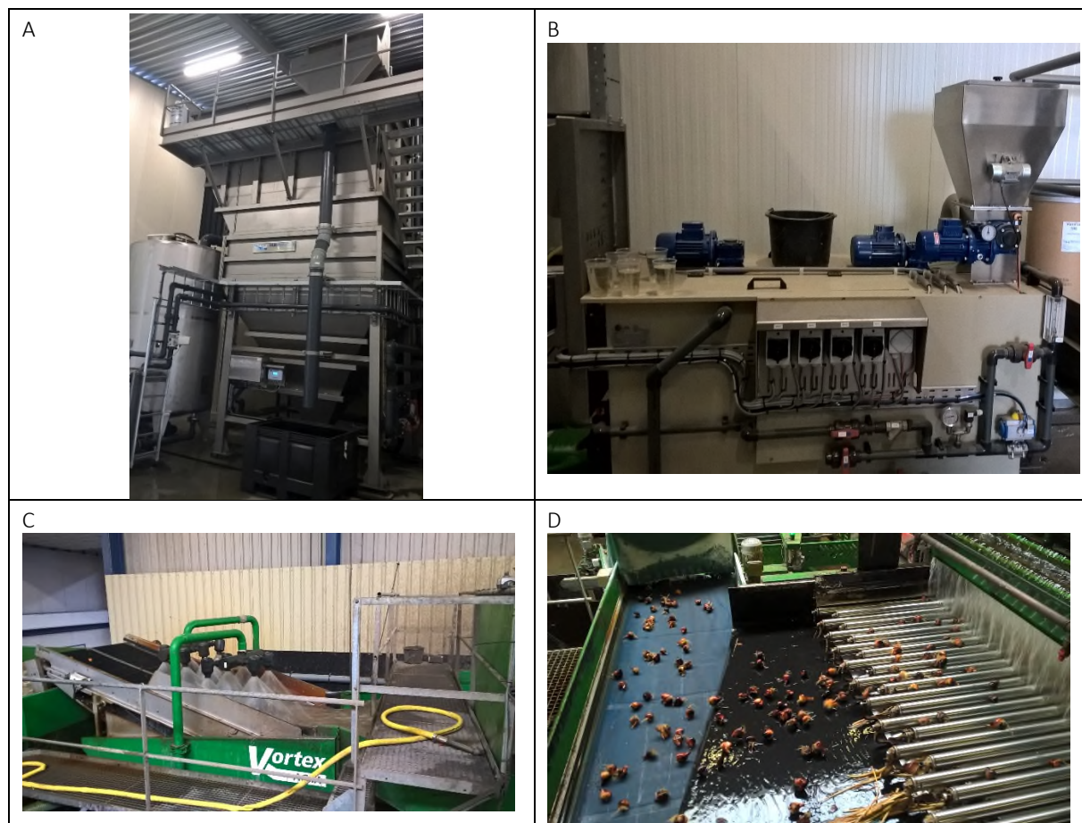
Figuur 3-10: lamellaseparator en flocculant bereiding bij Schutte. Spoelen van de bollen. Het water wordt in tegenstroom gebruikt met de aanvoer van de bollen waardoor het water wat uit de ozoninstallatie komt, wordt gebruikt voor de schoonste bollen (d). Dit water wordt opgevangen en nog 2x gebruikt voor het spoelen van de juist geogste bollen (c).
