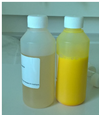
Figuur 4-3: referentiewater bereid in het lab. links verdund en rechts geconcentreerd referentiewater. De gele kleur wordt veroorzaakt door het middel Wing P.
