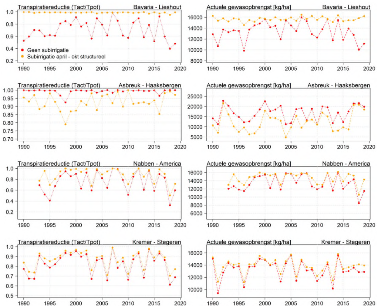
Figuur 6-3: Gemodelleerde transpiratiereductie per jaar over de maanden juni, juli en augustus met SWAP (links) en gemodelleerde gewasopbrengst per jaar (rechts) voor een simulatierun zonder subirrigatie en subirrigatie structureel tussen 1 april en 30 september.
