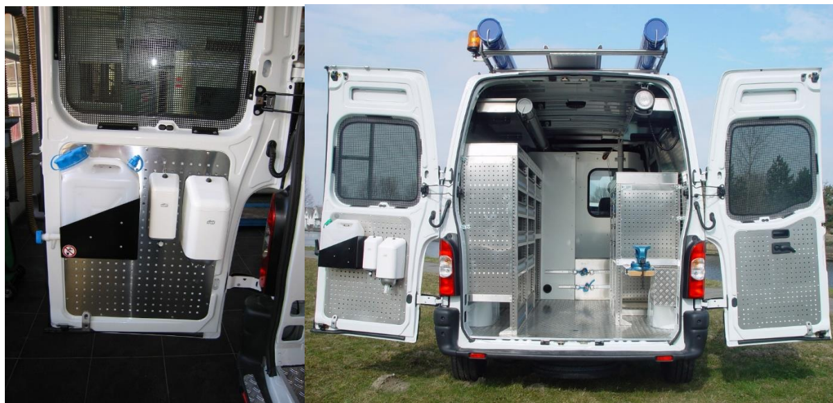
Foto 1 (Voorzieningen in) een monteursbus ten behoeve van hygiënisch werken (foto's Vitens).
