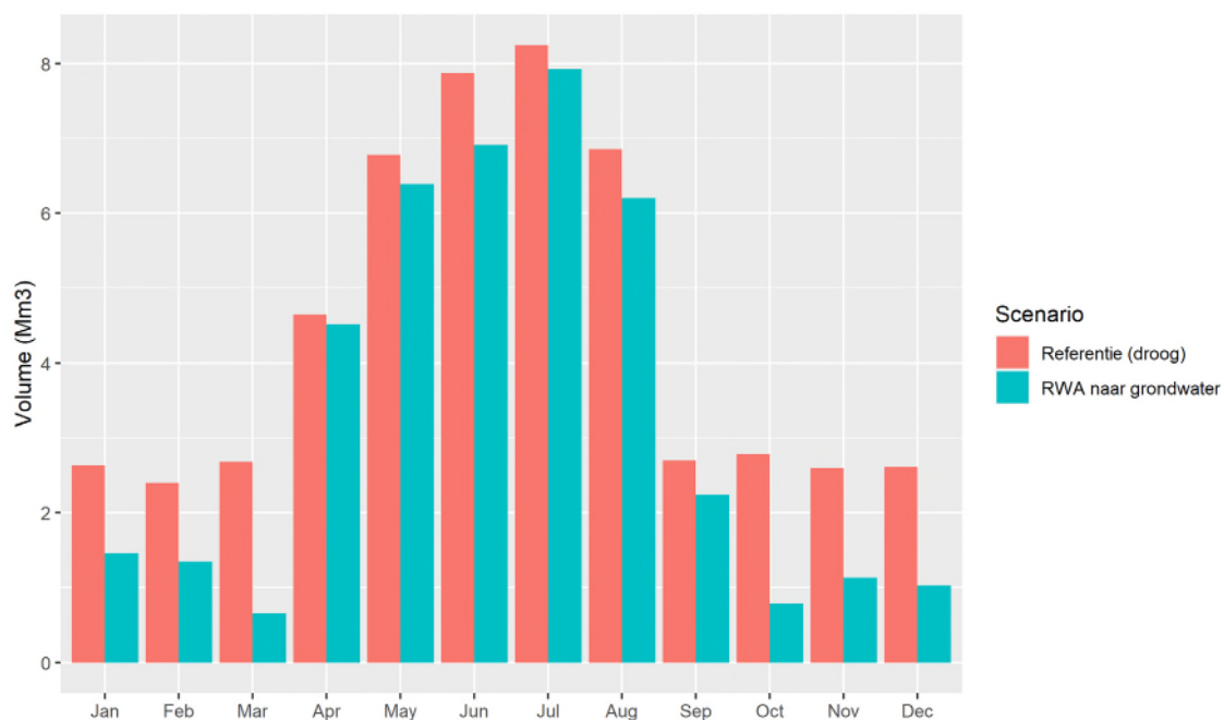
FIGUUR 3.16 TOTALE ANTROPOGENE DRUK OP HET GRONDWATER (DRINKWATER + INDUSTRIE + LANDBOUW) MINUS RWA-INFILTRATIE IN HET DERDE WATERFABRIEK- SCENARIO (RWA NAAR GRONDWATER), VERGELEKEN MET DE DROGE REFERENTIESITUATIE
