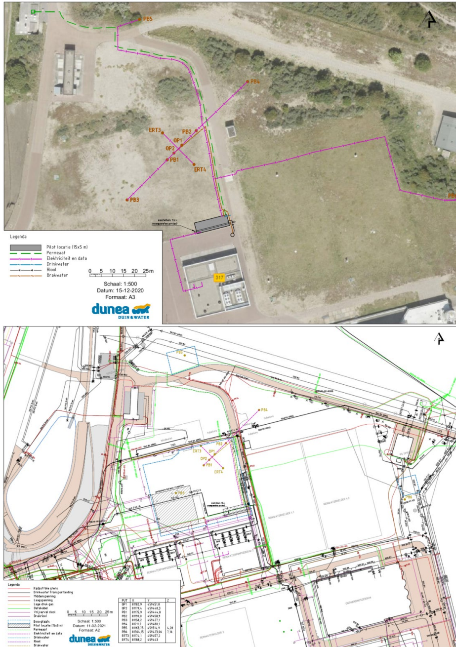
FIGUUR 6-10: OVERZICHT VAN BESTAANDE INFRASTRUCTUUR DIE DE CONNECTIE VORMT TUSSEN HET PUTTENVELD EN DE LOODS (PILOT LOCATIE) WAARIN MEET- EN ZUIVERINGSACTIVITEITEN PLAATS GAAN VINDEN TIJDENS DE PILOT (BOVEN), EN OVERZICHT VAN DE TE REALISEREN INFRASTRUCTUUR T.O.V. DE REEDS BESTAANDE INFRASTRUCTUUR..
