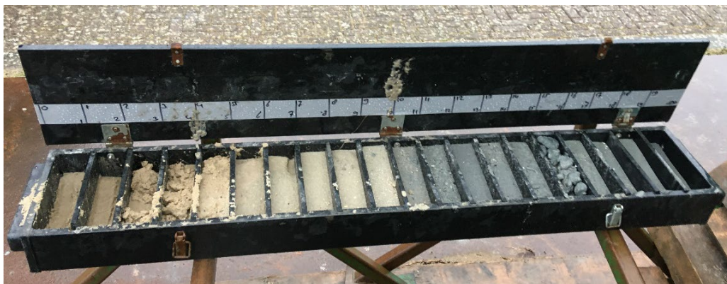
FIGUUR 4-2: GEROERDE STEEKMONSTERS AFKOMSTIG VAN 0 TOT 20 METER DIEPTE, GENOMEN DOOR HAITJEMA TIJDENS HET BOREN.
