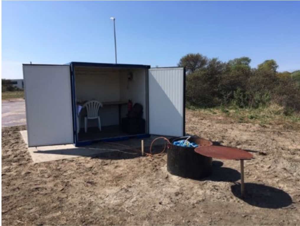
FIGUUR 4-13: CONTAINER DIE ALS ON-SITE WERKPLEK FUNGEERT, MET OP DE VOORGROND DE WAARNEMINGSPUT.
