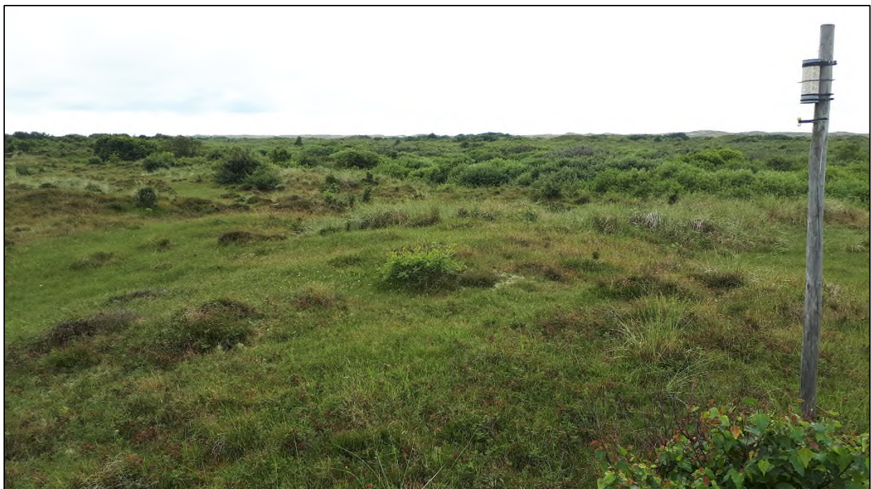
Figuur 4: MAN meetpunt voor de ammoniakconcentratie van de lucht van het RIVM in het Zwanenwater.
