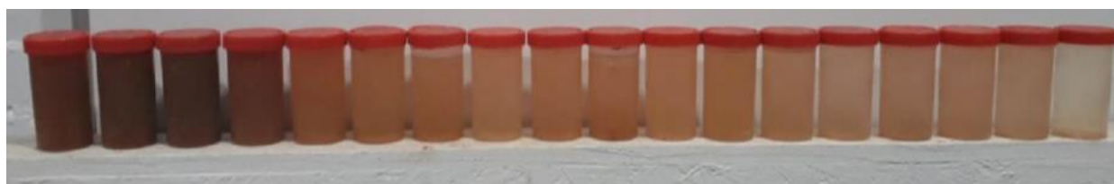
Figuur 4. Monsters van gesmolten ijsslurry zoals genomen tijdens run 3, elke monsterpotje is een minuut (foto SUEZ).
