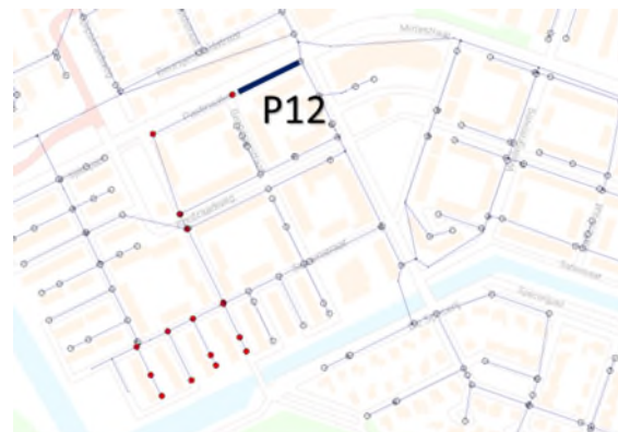
Figuur 3-3 Maximale watertemperaturen aan de tap voor de hotspots P12 en P13; in rood aansluitingen met temperatuur hoger dan 25°C.
