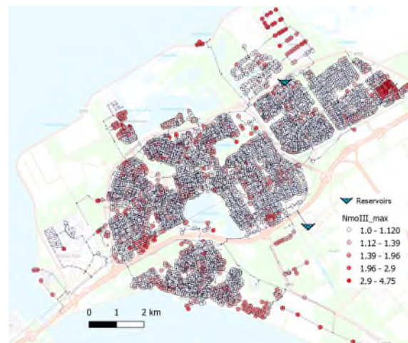
Figuur 3-5 a) maximale watertemperatuur en b) maximaal aantal micro-organismen type III voor multi-hotspot-scenario THS=40°C
