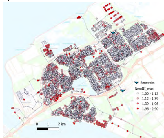
Figuur 3-4 a) Locatie van hotspots en eigenschappen van de leidingen, b) maximale watertemperatuur, c) maximaal aantal micro-organismen type I, c) maximaal aantal micro-organismen type II, en d) c) maximaal aantal micro-organismen type III voor multi-hotspot-scenario.
