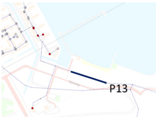
Figuur 3-3 Maximale watertemperaturen aan de tap voor de hotspots P12 en P13; in rood aansluitingen met temperatuur hoger dan 25°C.
