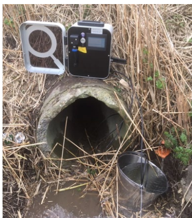
Figuur 2-2: Bemonstering van drainwater. De drain is rechtsonder zichtbaar in oranje. Het uittredende drainwater is opgevangen in een stalen emmer en vervolgens zijn de veldparameters geanalyseerd en is het drainwater bemonsterd voor analyses in het lab. De betonnen buis is een duiker van de sloot die momenteel het drainwater vanaf het perceel verzameld.
