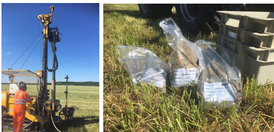
Figuur 2-3: Uitvoering van de proefboring en een impressie van de geroerde bodemmonsters.
