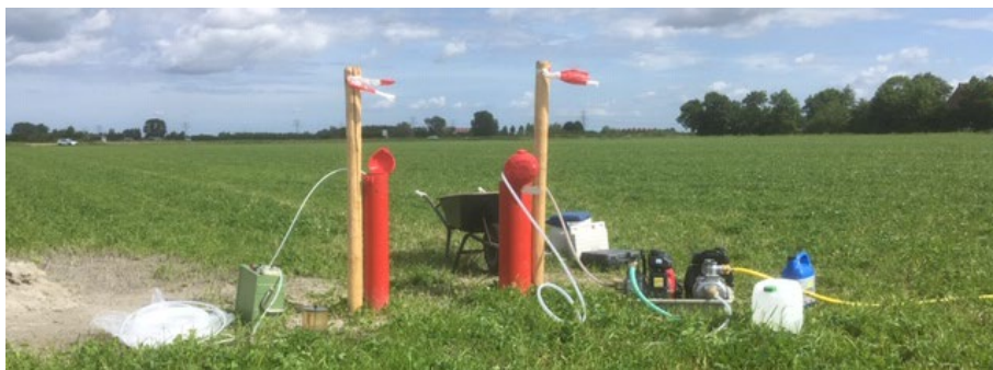
Figuur 2-4: Veldimpressie van de geplaatste peilbuizen tijdens de bemonstering van grondwater.
