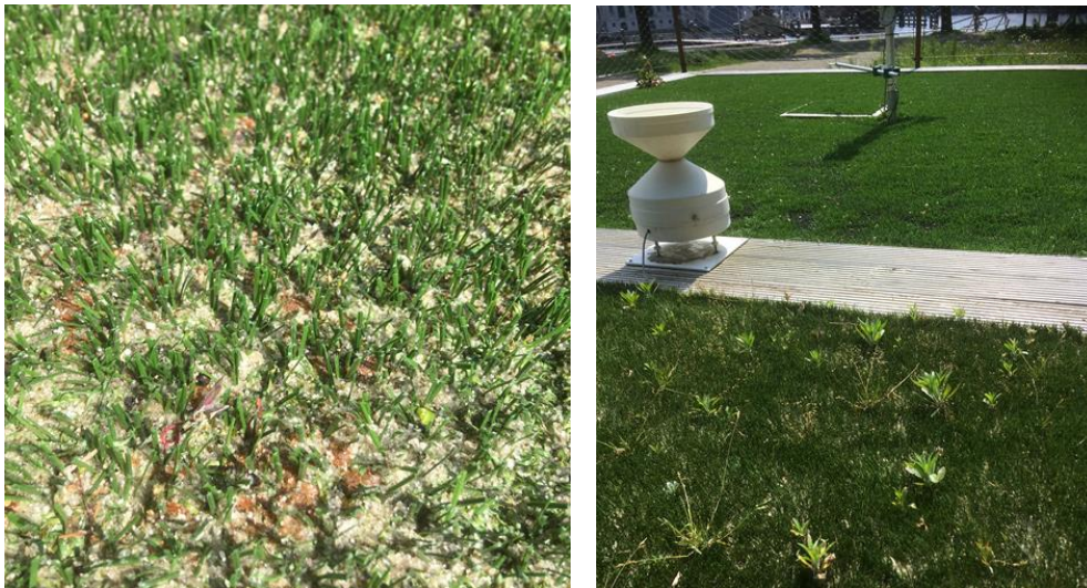
Figuur 5 Plaques van algen/bacteriën op de infill van de capillair geïrrigeerde (onbespeelde) proefvlakken (links) en verschil in opslag van planten tussen het capillair geïrrigeerde proefvlak met de standaard mat en het conventionele vlak (rechts).
