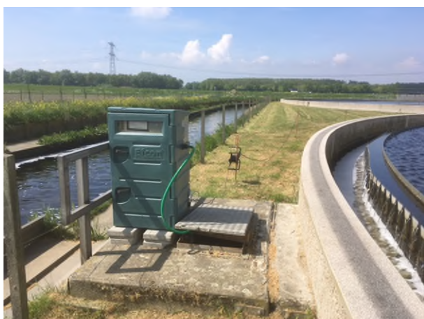
Figuur 4: Systeem dat is gebruikt om automatisch een 24-uurs monster te kunnen nemen van het in- en effluent
