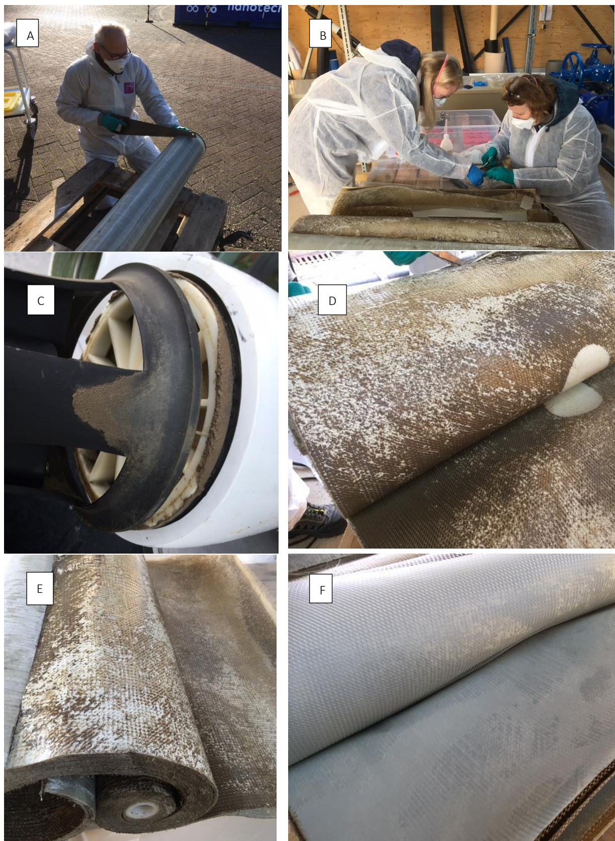
Figuur 6-13 Membraanautopsie van de FO-elementen van de CoRe-pilot in week 49 2021. A) Het openzagen van het membraan. B) Het uitknippen van coupons voor verdere analyse. C) Vervuiling van de FO-module. D) en E) Vervuiling van de membraanvoedingszijde. F) De drawoplossing zijde
