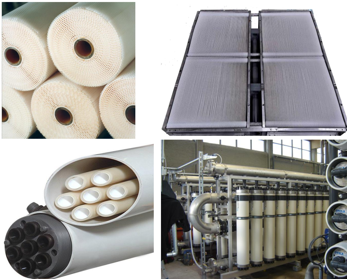
Figuur 8-1 Spiraalgewonden membranen, ondergedompelde plaatmembranen, capillaire/tubulaire membranen en een capillaire membraansysteem (van linksboven naar rechtsonder). Let wel, dit zijn geen FO membranen
