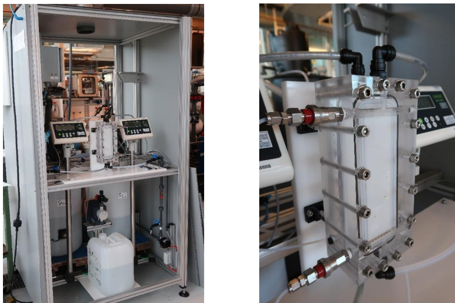
Figuur 4-1 Foto's FO cross-flow laboratoriuminstallatie. Links installatie met rechts de cross-flow cel
