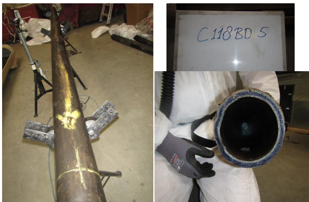
Figuur 29 Uitvoering van de meting: rechtsboven de referentie van de onderzochte buis; links de meting met georadar, waarbij de pijl de in de sleuf aangebrachte bovenzijde weergeeft en de dunne gele lijnen de posities van de georadarmetingen; rechtsonder het resultaat van een thymolftaleïnetest, waarbij de grijze kleur het uitgeloopte deel van de buiswand weergeeft.
