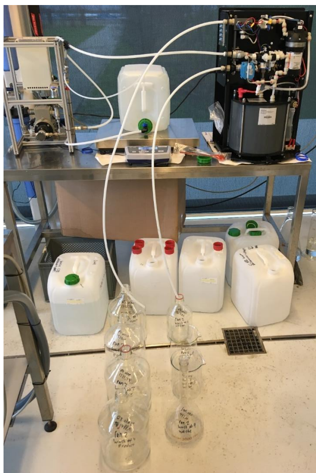
Figuur 9: Overzichtsfoto van de CapDI DiUse opstelling tijdens één van de experimentele runs. Vanuit het voedingsvat op de bovenweger (midden op de tafel) wordt via de tandradpomp (links op de tafel) het water gevoed aan de CDI module (rechts op de tafel). De product- en regeneraatstroom worden separaat opgevangen in glaswerk.
