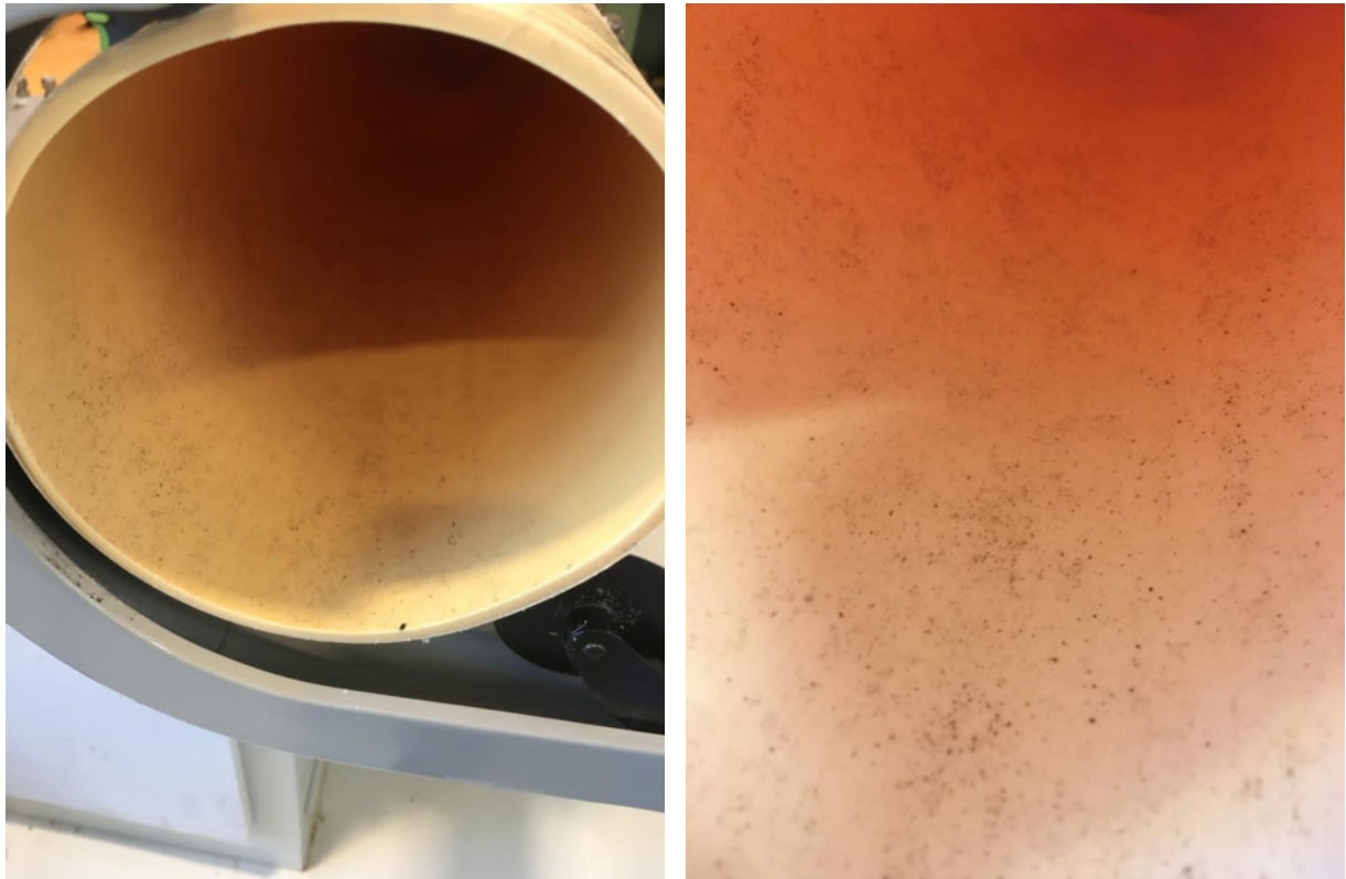
Figuur 3. Uitgenomen leiding van Evides (links) en close-up van de biofilm op de onderkant van de leiding (rechts).
