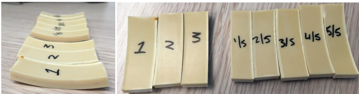
Figuur 4. Leidingstukjes van de uitgenomen leiding van Evides. Te zien is dat de stukjes erg dik zijn en dat de grootte tussen de plaatjes verschilt.
