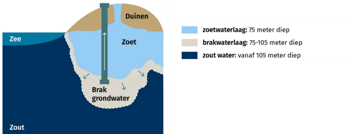
Figuur 5.5: Schematische weergave van de brakwaterwinning in duingebied Meijendel.
