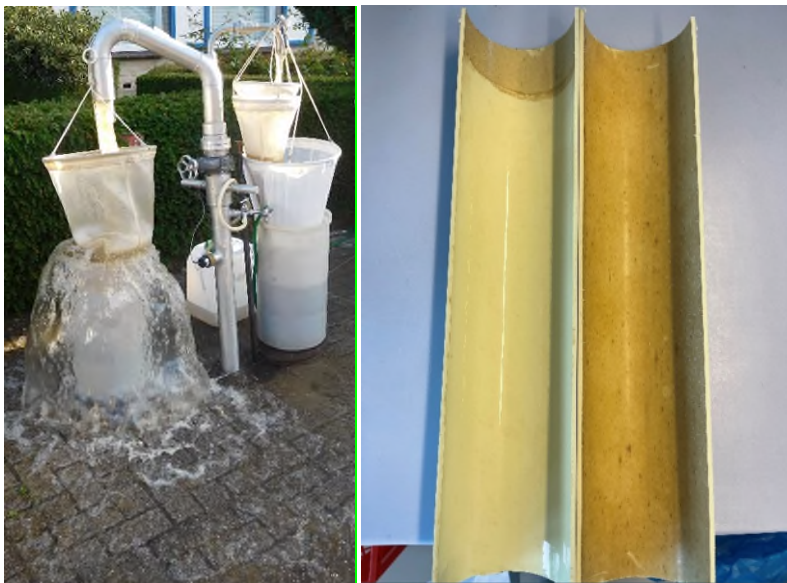
Spuiacties en buisuitnamen zijn uitgevoerd om te bepalen in welke niche (drinkwater, buiswandbiofilm, sediment) de bacteriesoorten Aeromonas , Legionella en bacteriën van de coligroep vóórkomen.
