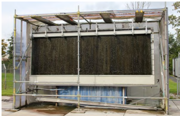
Figuur 8: Pilotscale van een open fototrofe biofilmreactor (links) en de lichtintensiteit ( \mu\text{mol}/\text{m}^2/\text{s} ) en nitraatconcentraties van influent en effluent gedurende twee dagen (rechts). Uit: Boelee et al., 2014.
