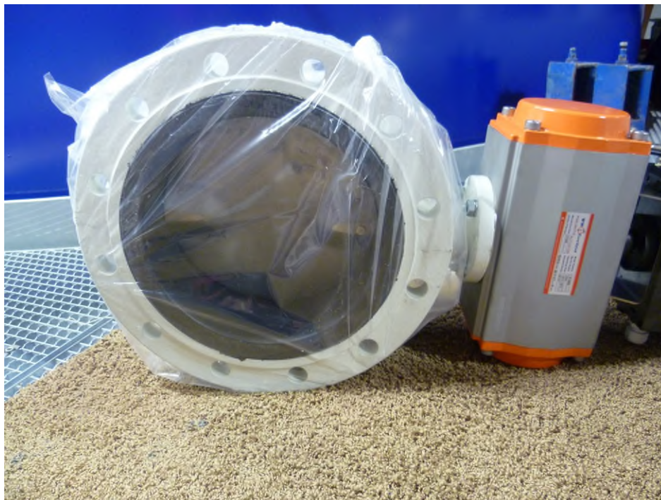
Foto 7 Bescherming tegen vervuiling en beschadigingen van zuiveringsonderdelen tot op de werkplek (foto Vitens).
